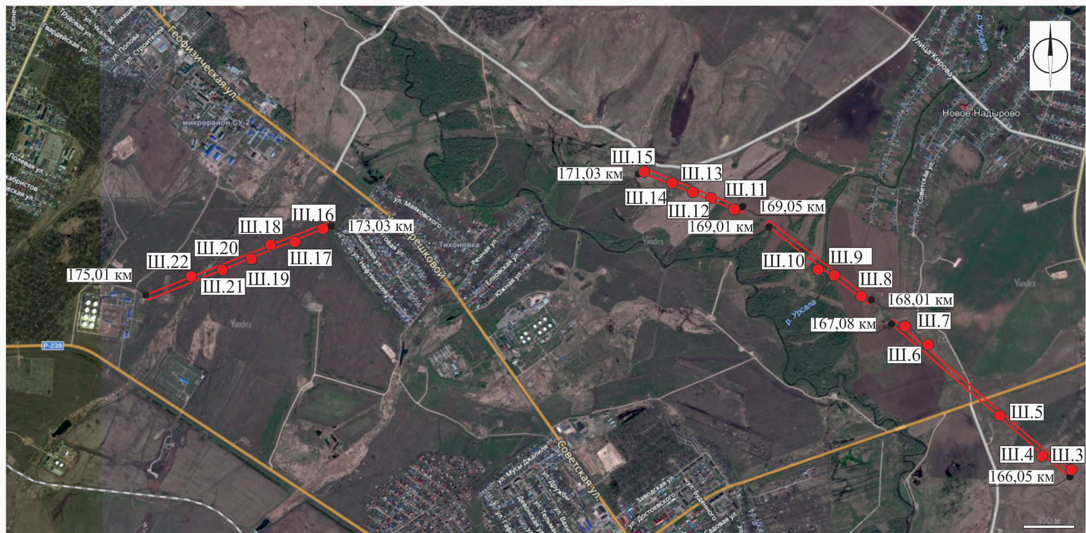
Рис.3. Карта-схема участка проведения работ на объекте «МН «Катласы-Куйбышев», участок Азнакаево-Альметьевск (158,5-159,2 км), (166,05-167,8 км), (168,1-169,1 км), (169,5-171,3 км),(173,3-175,1 км) Ду-700, АРНУ ОАО «СЗМН». Реконструкция», с указанием места заложения шурфов (на космоснимке)
